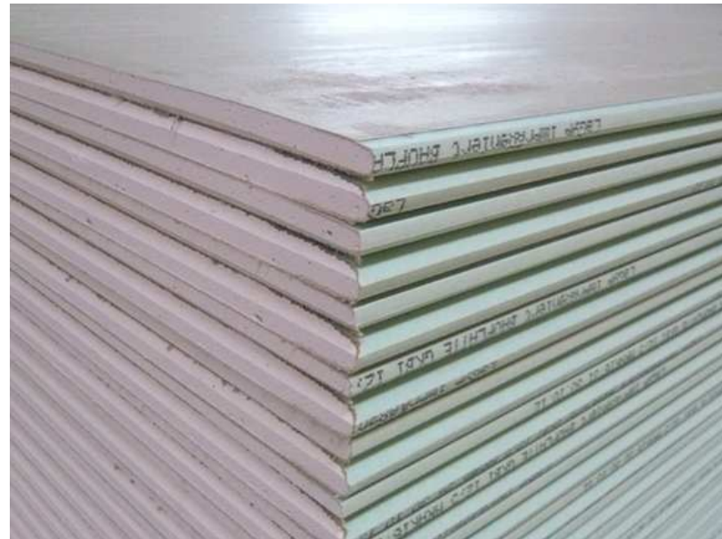
Gipskarton (verschiedene Varianten) Rohdichte ca. 0,68 g/cm 3 (+/-)
